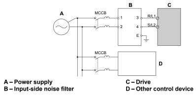
Figure 8.5 Input-Side Noise Filter (Single-Phase 200 V)
